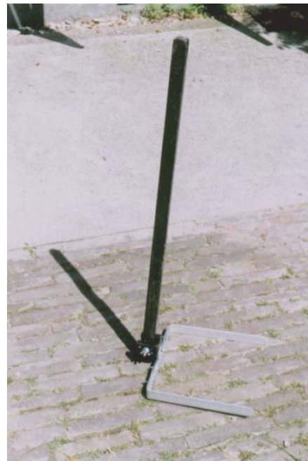
Voorbeeld van een U-vormige mal om vegetatieplots mee uit te zetten
